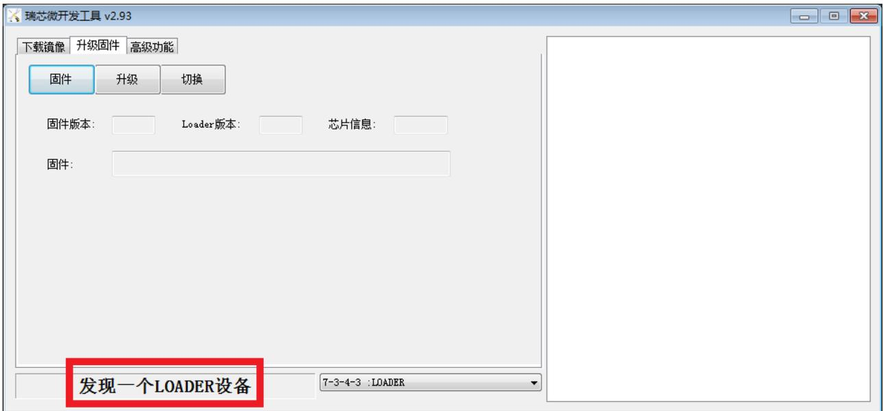
方式一、将主板断电，首先用 TYPE-C 线将主板与 PC 机连接好，按下主板上的 BOOT 键，并保持按下状态，然后再上电开机，主板会进入 Loader 操作模式，注意这种方式适用于主板上的 BootLoader 可正常工作的情况。
